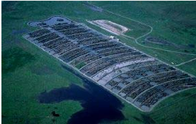
Hình 23.16: Sơ đồ xử lý nước thải bằng cánh đồng lọc
